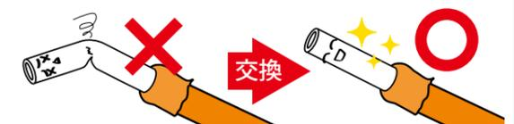
**注意** ●管は継手や支持部材を支点到に曲げないでください。また急激な力を加えた曲げ加工はしないでください。管・継手が破損するおそれがあります。
